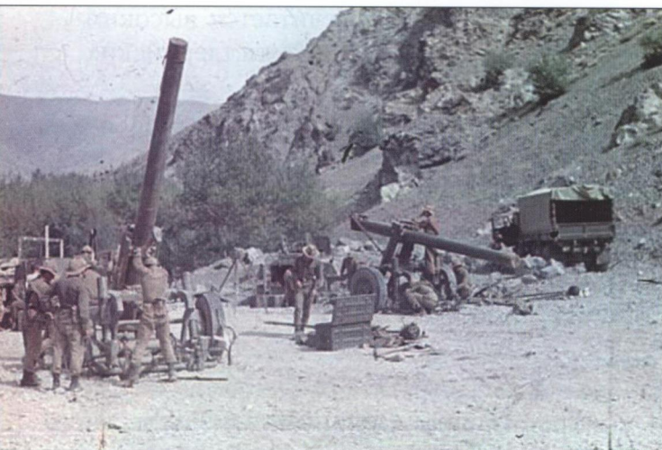
240-мм минометы в Афганистане: слева в положении для стрельбы, справа – в положении для заряжания
